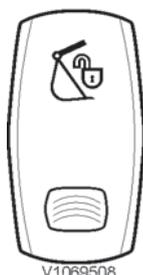
Otwarcie hydraulicznego szybkozłącza osprzętu
