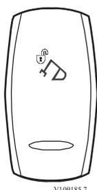
Zwolnienie blokady wysięgnika koparki podsiębiernej (tylko za pomocą dźwigni koparki podsiębiernej, sterowanie mechaniczne)
